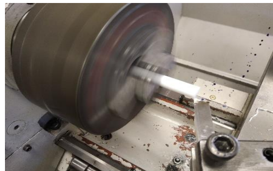
Figura 3 Careado de sección transversal
