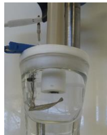
Figura 9 Prototipo Aislante de Teflón instalado en el eje de trabajo de la máquina
