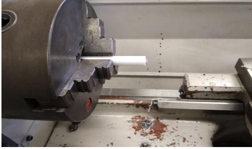
Figura 4 Cilindrado de barra de teflón
