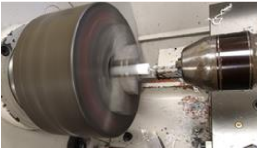
Figura 5 Barrenado de barra
